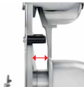
Ampio spazio tra lama e corpo macchina Wide space between blade and motor
