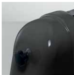
Manopola regolazione spessore taglio Cut thickness adjusting knob
