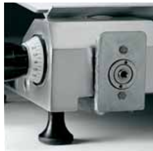
Meccanismo sgancio piatto Device for releasing the carriage
