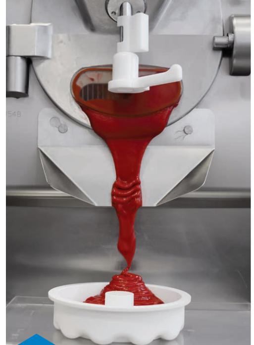
Grazie al **distanziale**, che può essere montato in qualsiasi momento, è possibile ridurre l'apertura dello sportellino di uscita facilitando così l'estrazione del prodotto Crystal e il lavaggio macchina.
