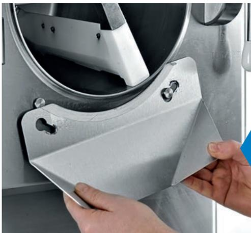
Con il **lavaggio a caldo** del cilindro e lo scivolo di uscita del gelato smontabile, la pulizia è facilitata.
