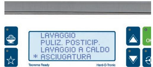
**Completato il lavaggio, dal cilindro può essere eliminato ogni residuo di umidità**, con il programma di asciugatura, indispensabile prima della tempera del cioccolato.
