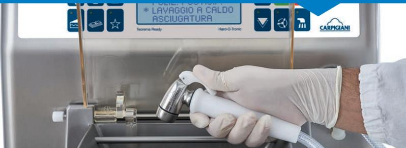
Anche la pulizia delle lamiere è rapida, perché con **il trattamento Scotch-Brite**, l'acciaio inox è anti-macchia e non trattiene i residui di grasso.
