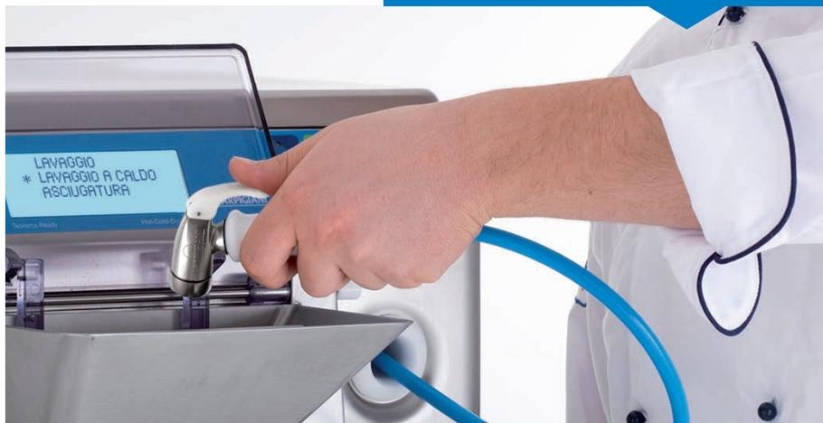
Lo scivolo di uscita dei prodotti è smontabile, per facilitare la completa rimozione di ogni residuo di gelato, creme o cioccolato, per una pulizia integrale.
