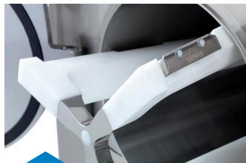
Agitatore in POM impenetrabile al freddo e al caldo, per la **completa espulsione del gelato e delle creme**; ha pattini raschianti autoregolanti per la totale pulizia e resa del cilindro.
