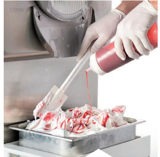
Grazie all'inverter è possibile **variare il gelato** in vaschetta senza fermare la macchina o chiudere il portello: la velocità dell'agitatore può essere ridotta fino ad interrompere completamente l'uscita del gelato e consentire la comoda distribuzione dei topping; aumentando poi la velocità, l'uscita del gelato riprende.
